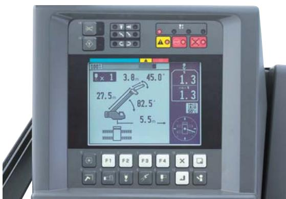
起伏角度、ブーム長、作業半径、アウトリガ張出幅等の作業状況を1つの画面に液晶表示。安全な作業を見守ります。
